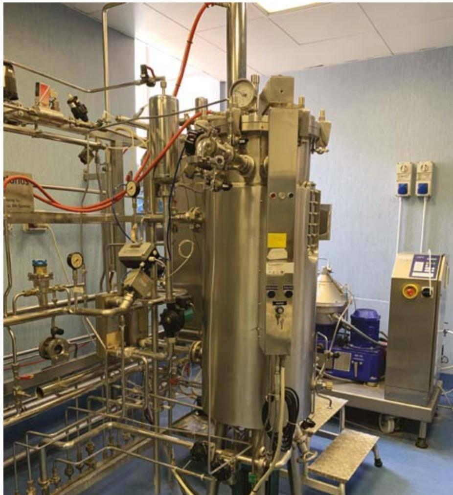
Fermentatore da 500 litri per la messa a punto di processi pilota di produzione in ambito biofarmaceutico
